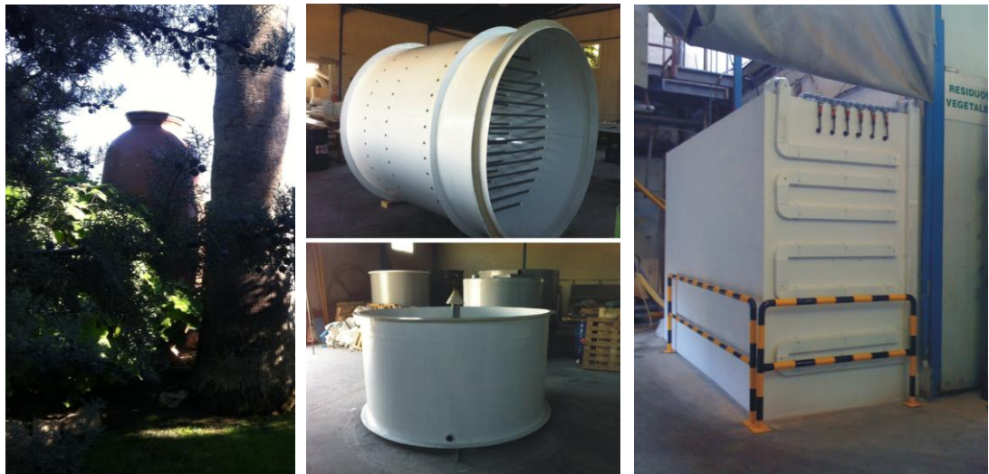
Prefabricado doméstico, en tinaja, y reactor industrial en prefabricado y en situ
